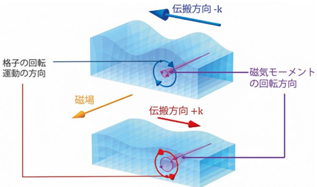
図1 磁気と回転の結合によるレイリー波の整流
